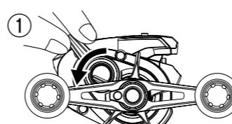
レバーを支えながら、ロックリングをハンドル回転と逆方向に回転させ緩めます。
