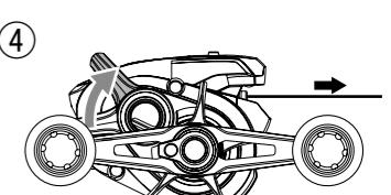
ロックリングを回転方向に回転させしっかりと締めこみます。
